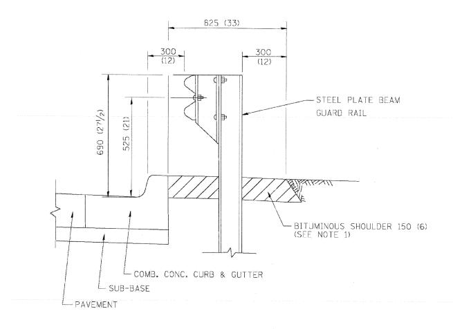
NOTES: 1. THE BITUMINOUS SHOULDER SHALL EXTEND UNDER THE TRAFFIC BARRIER TERMINAL
