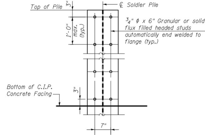
**SHEAR STUD CONNECTORS LAYOUT**
