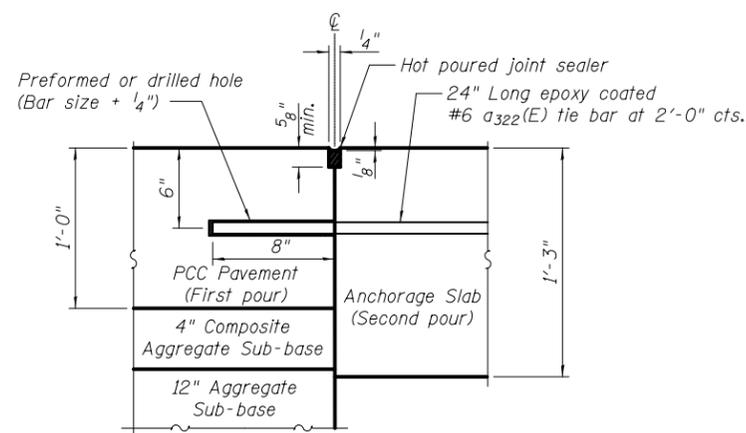
**LONGITUDINAL CONSTRUCTION JOINT GROUTED-IN-PLACE TIE BAR**
