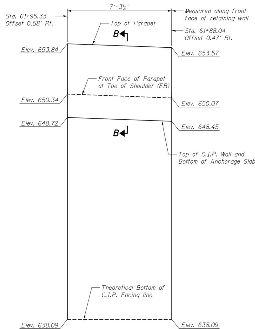
**ELEVATION VIEW OF C.I.P. FACING ALONG I-74 EB**
