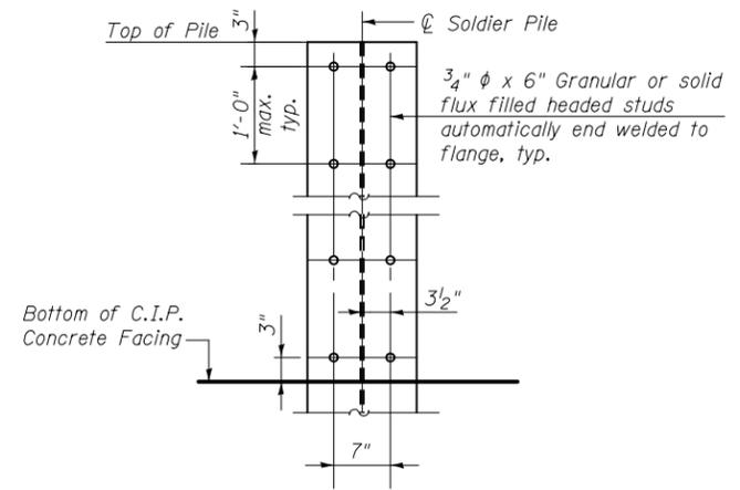
**SHEAR STUD CONNECTORS LAYOUT**
