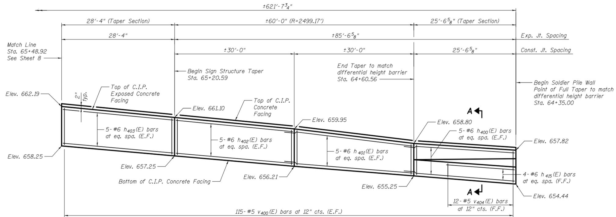
**PARTIAL ELEVATION - SOLDIER PILE WALL**
