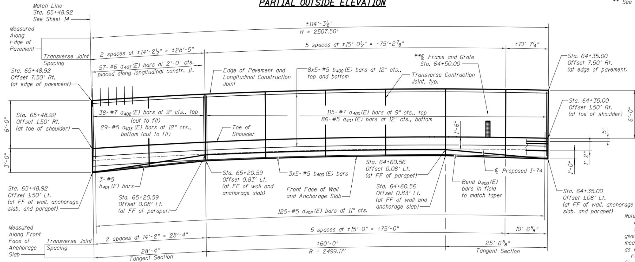
**PARTIAL PLAN - PARAPET AND ANCHORAGE SLAB**
