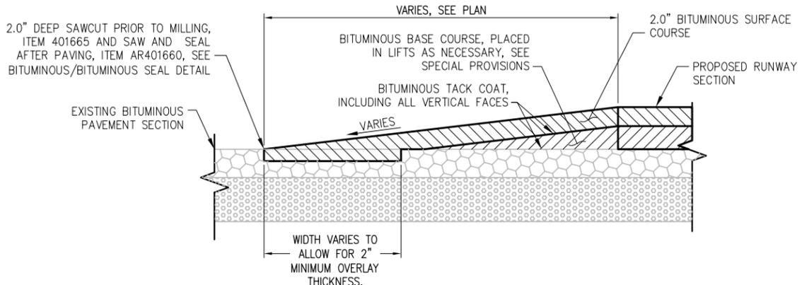
**BITUMINOUS TAPER DETAIL**
