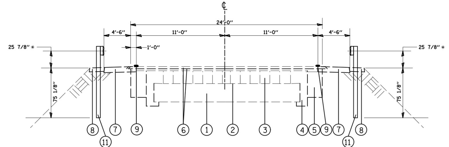
\* HEIGHT OF GUARDRAIL IS INCREASED BY 1 " IN PREPARATION FOR FUTURE RESURFACING
