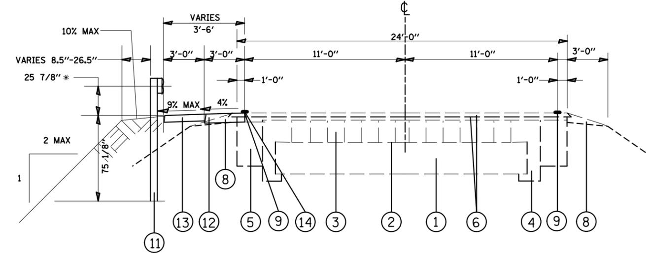
\* HEIGHT OF GUARDRAIL IS INCREASED BY 1 " IN PREPARATION FOR FUTURE RESURFACING
