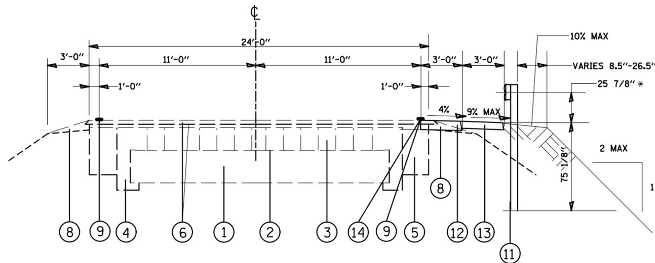
\* HEIGHT OF GUARDRAIL IS INCREASED BY 1 " IN PREPARATION FOR FUTURE RESURFACING
