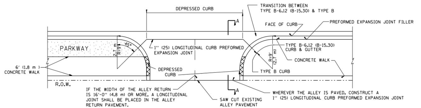
IF THE WIDTH OF THE ALLEY RETURN IS 16'-0" (4.8 m) OR MORE, A LONGITUDINAL JOINT SHALL BE PLACED IN THE ALLEY RETURN PAVEMENT.
