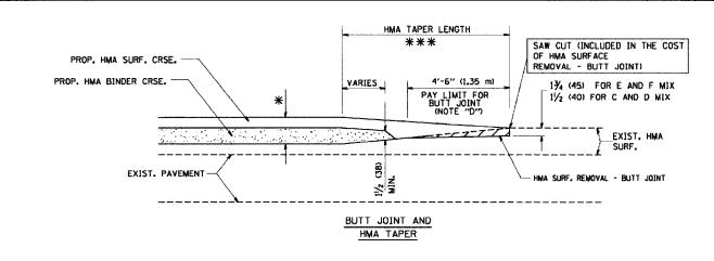
TYPICAL BUTT JOINT AND HMA TAPER
