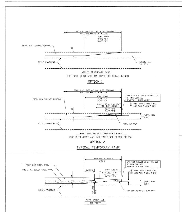
TYPICAL BUTT JOINT AND HMA TAPER
