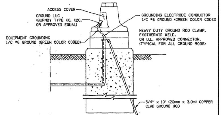
**MAST ARM POLE / POST-GROUNDING DETAIL**
