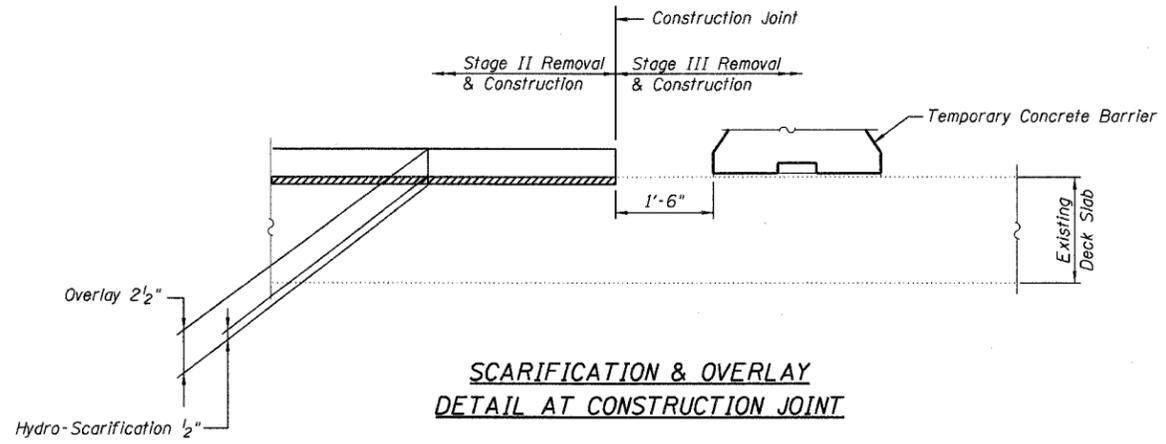
SCARIFICATION & OVERLAY DETAIL AT CONSTRUCTION JOINT
