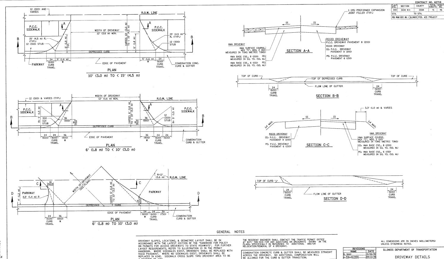
WHEN THE DISTANCE BETWEEN R.O.W. AND THE BACK OF CURB IS EQUAL TO OR LESS THAN 8' (2.4 m), THE P.C.C. SIDEWALK SHALL EXTEND TO THE BACK OF CURB.
