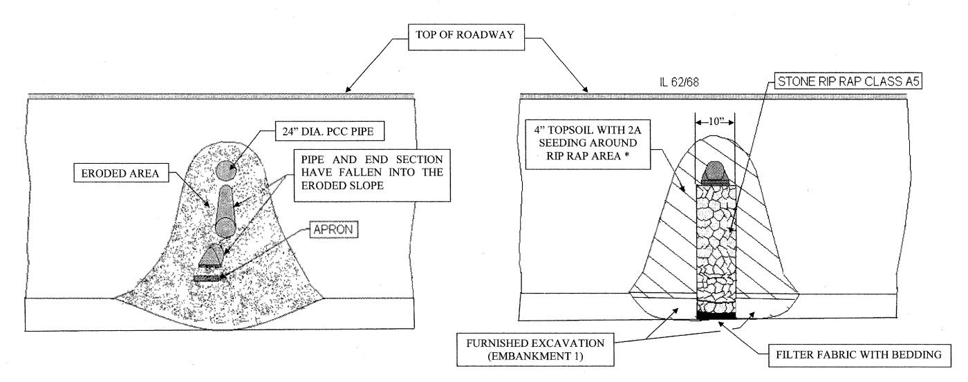
\* INCLUDES EROSION CONTROL BLANKET FERTILIZER INTETIONALLY OMITTED
