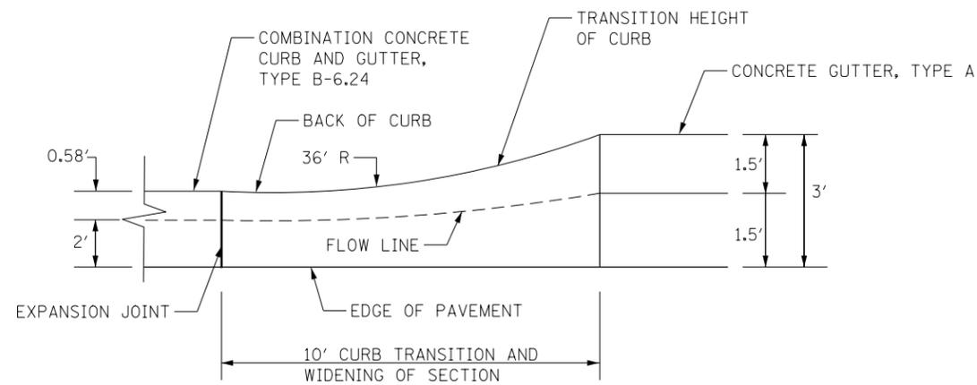
**DETAIL - B-6.24 CURB TRANSITION TO TYPE A GUTTER**
