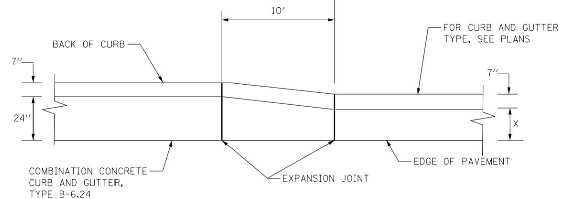
**DETAIL- B-6.24 CURB TRANSITION TO B-6.12 OR B-6.18 CURB**
