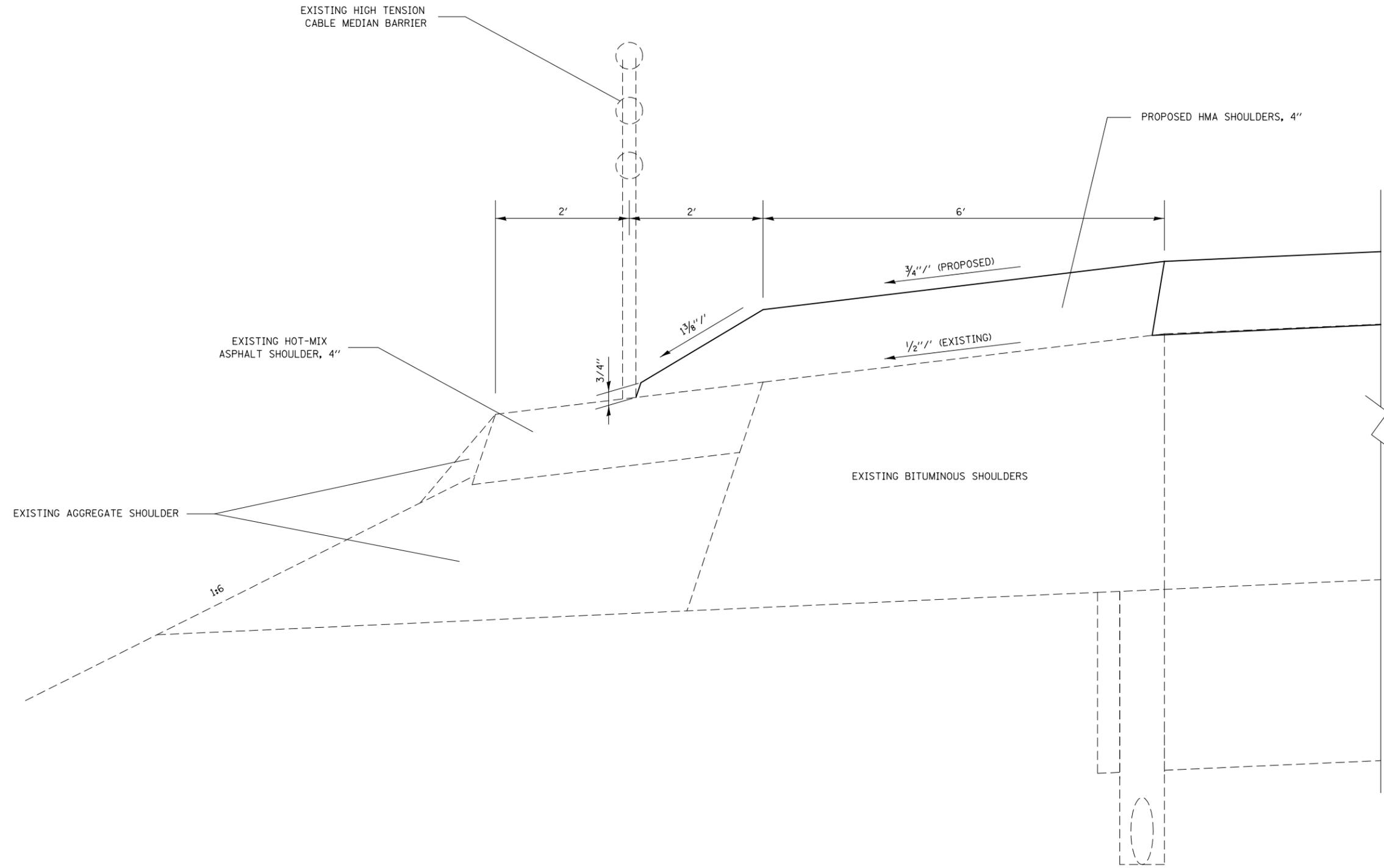
HOT-MIX ASPHALT TAPER AT CABLE MEDIAN BARRIER DETAIL
