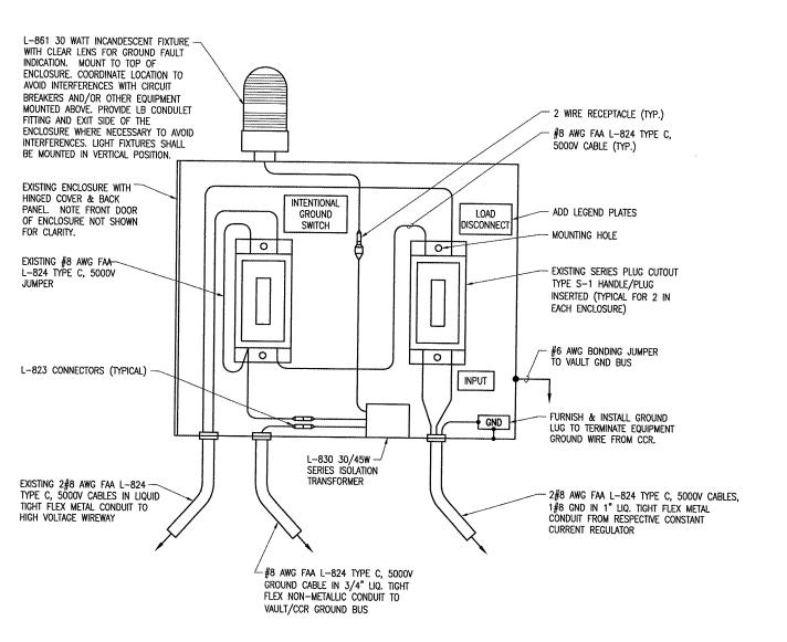
PROPOSED SERIES PLUG CUTOUT INSTALLATION DETAIL FOR AIRFIELD LIGHTING CIRCUITS (TYPICAL FOR 7)
