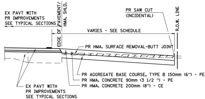
**SECTION A-A FOR EX HMA PE & CE**
