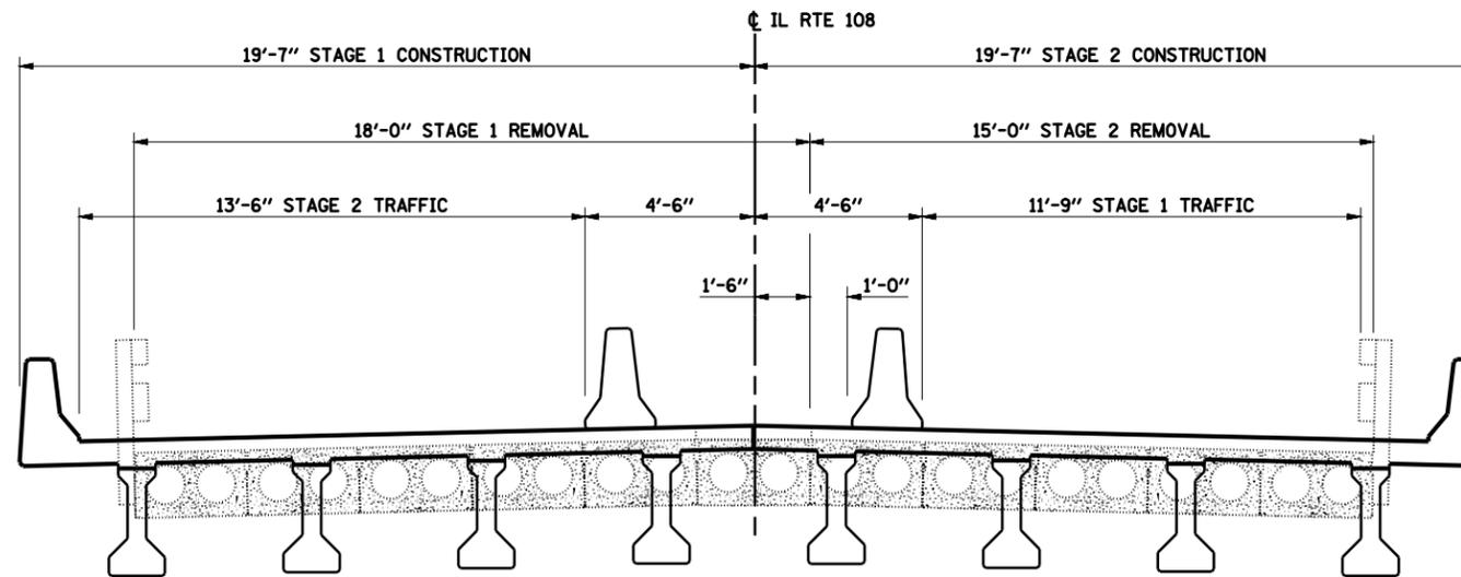
**STAGED CONSTRUCTION SPANS 2 & 3**
