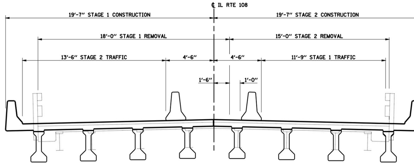
**STAGED CONSTRUCTION SPANS 1, 4, 5 & 6**
