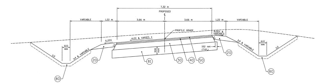
FROM STATION 0+930 TO STATION 0+953, THE EXISTING PAVEMENT SHALL BE WIDENED FROM 0.3 m STUBS AT 0+930 TO 3.66 m LANE WIDTHS AT 0+953. ONLY HMA SURFACE COURSE SHALL BE PLACED ON THE WIDENED
