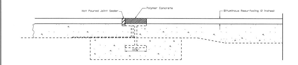
WIDE FLANGE BEAM TERMINAL JOINT SECTION SB STA. 110+90.00
