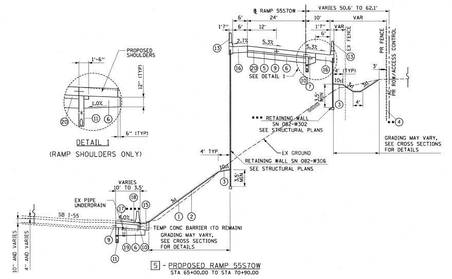
\* SEE SE TRANSITION DATA TABLE FOR SUPERELEVATION TRANSITIONS \*\* PR FENCE RIGHT ENDS AT STA 68+87.08 \*\*\* LIGHTWEIGHT CELLULAR CONCRETE FILL FROM STA 67+75.00 TO STA 70+40.00 \*\*\*\* SB I-55 SHOULDER AND COMB CC&G ENDS AT STA 67+47.29
