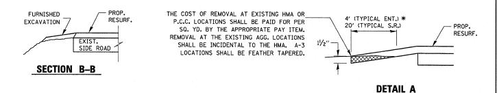
FURNISHED EXCAVATION AS REQUIRED-TO MEET HMA SURFACE SEE SCHED./PLAN -MATCH EXIST. RADIUS EDGE OF PAV'T. EDGE OF AGG. SHOULDER OR HMA SHLD. TYP. AGG. SHOULDER IS NOT TO BE PLACED AROUND SIDE ROAD RADII
