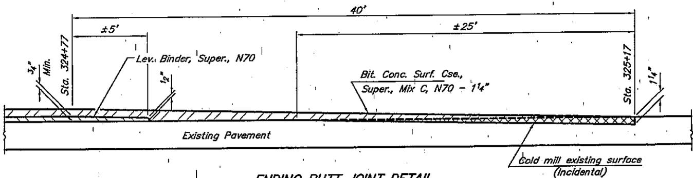
**ENDING BUTT JOINT DETAIL**
