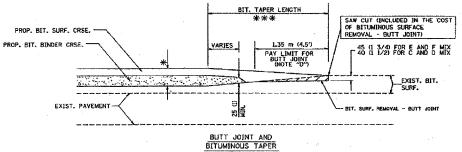
TYPICAL BUTT JOINT AND BITUMINOUS TAPER FOR MILLING AND RESURFACING
