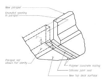
SILICONE JOINT SEAL @ PARAPET
