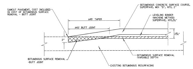
BITUMINOUS SURFACE REMOVAL - BUTT JOINT
