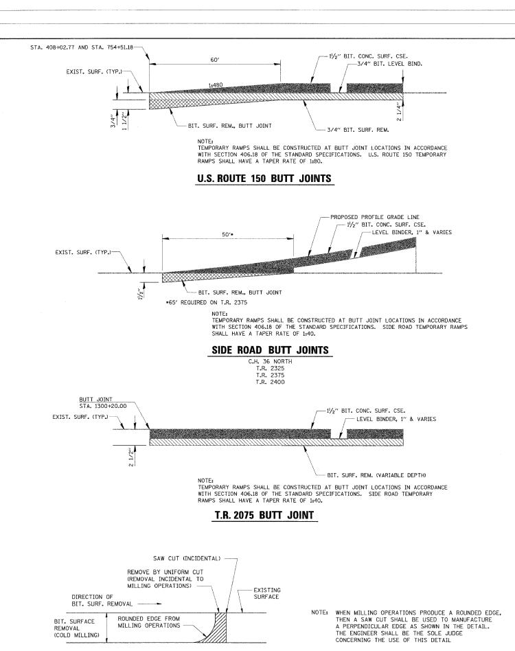
**BITUMINOUS DETAILS AT BUTT JOINTS**
