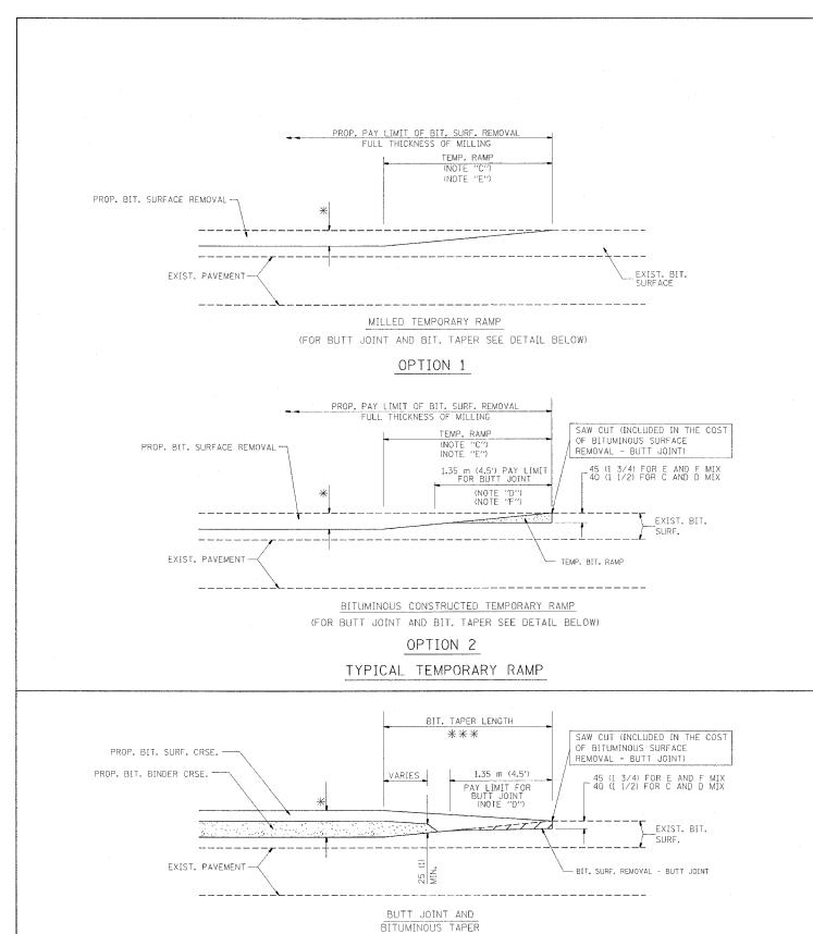
TYPICAL BUTT JOINT AND BITUMINOUS TAPER
