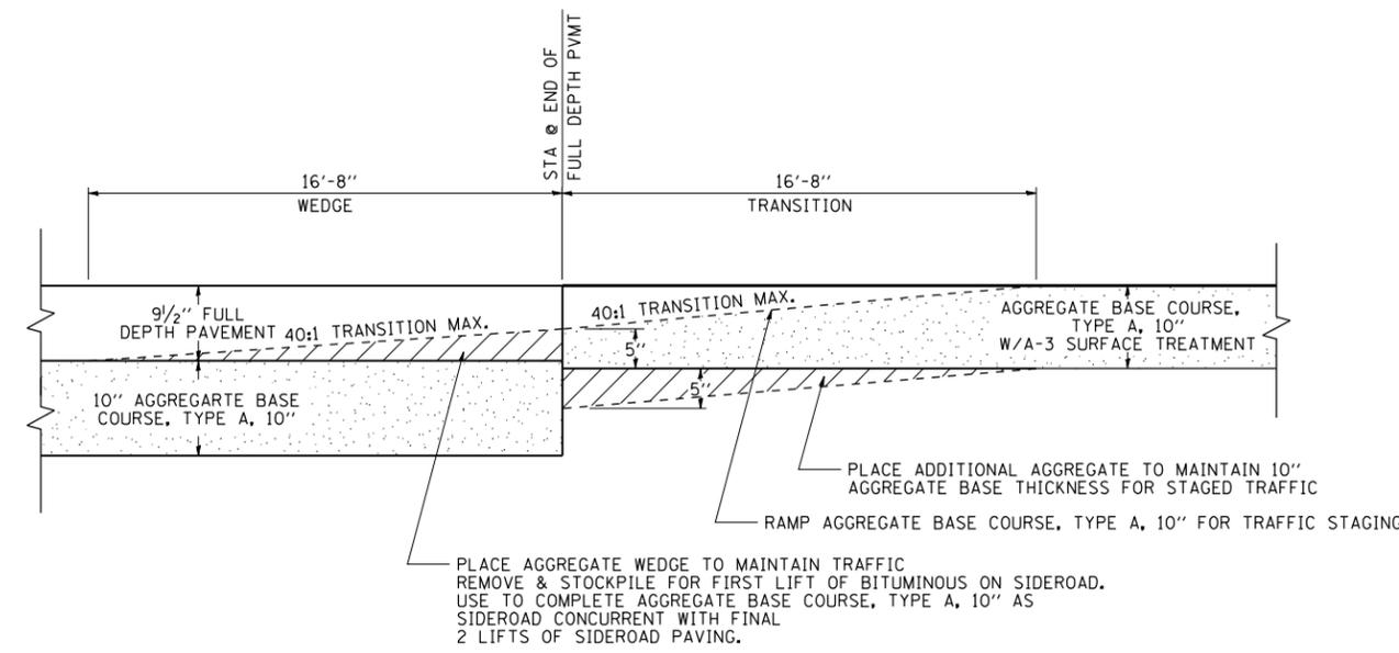
SIDEROAD BITUMINOUS/A-3 SURFACE STAGED CONSTRUCTION TRANSITION
