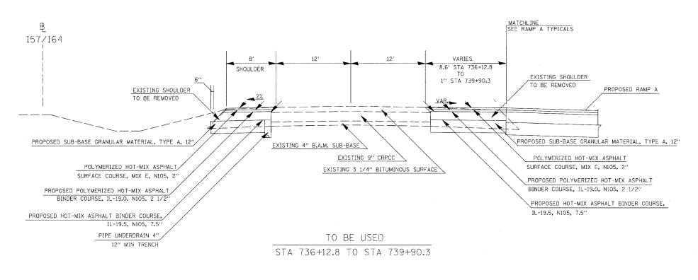
\* SEE GUARDRAIL SCHEDULE AND DETAIL FOR GUARDRAIL SHOULDER WIDENING
