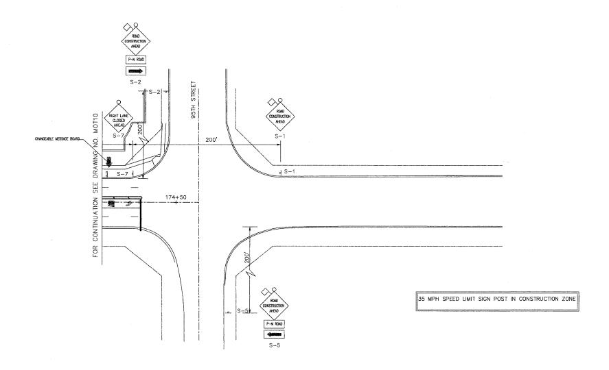
LEGEND PLASTIC DRUMS W/STEADY BURN LIGHTS @ 25FT SPACING TYPE : OR TYPE II BARRICADES W/STEADY BURN LIGHTS \$ 50' C-C ON TANGENTS; 25' C-C ON TAPERS TYPE III BARRICADES W/STEADY BURN LIGHTS TRAFFIC LANE TRAFFIC SIGN FLASHING ARROWBOARD
