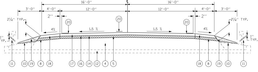
STA 114+26.00 TO STA 116+00.00 NC, GUARDRAIL RT ONLY STA 115+20.00 TO STA 116+00.00 NC, GUARDRAIL LT ONLY
