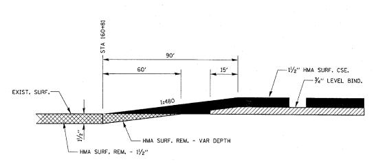
TAPER DETAIL AT MILLING TRANSITION
