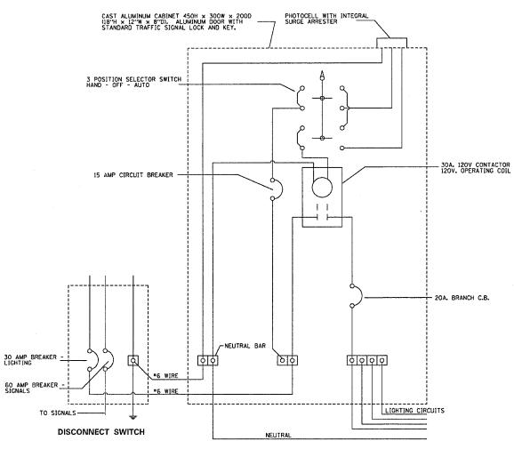
LIGHTING CONTROLLER (PHOTOCELL RELAY)
