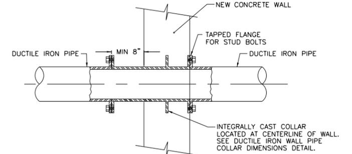
**FLANGE /FLANGE DUCTILE IRON WALL PIPE DETAIL**
