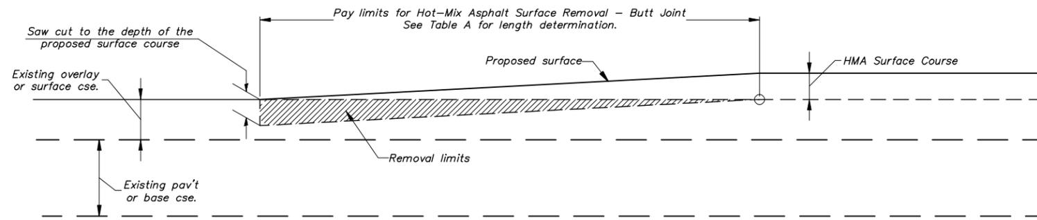
**CASE 1: BUTT JOINT w/ SURFACE OVERLAY**
