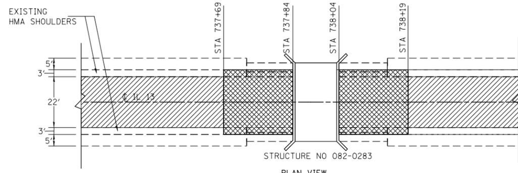
HOT-MIX ASPHALT SURFACE REMOVAL - BUTT JOINT
