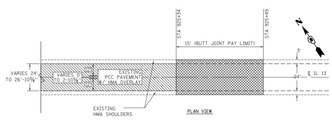
HOT-MIX ASPHALT SURFACE REMOVAL - BUTT JOINT
