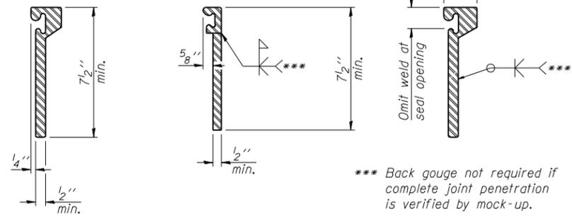
**SECTION THRU ROLLED RAIL JOINT**
