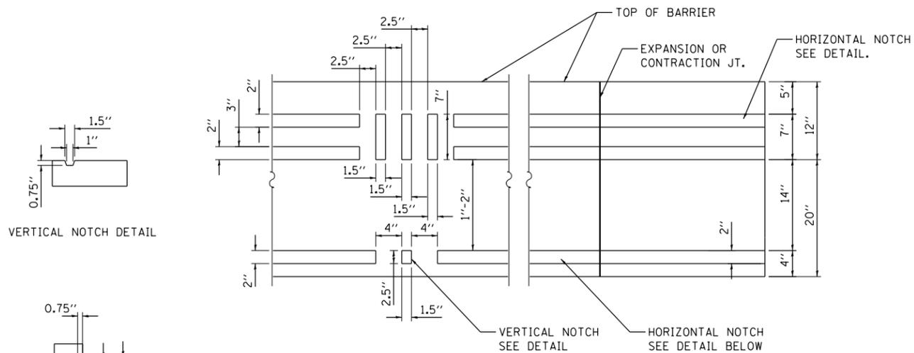
**CONCRETE BARRIER, SINGLE FACE, 42" HEIGHT (SPECIAL), TYPE 2.
