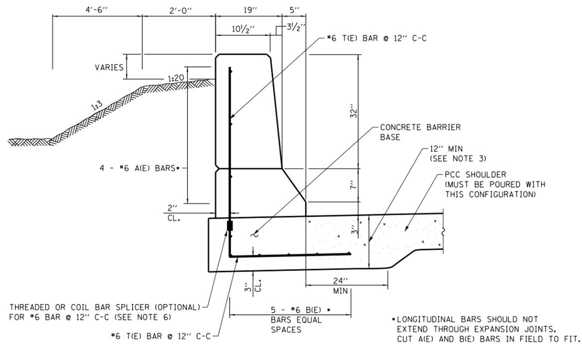
**CONCRETE BARRIER, SINGLE FACE, 42" HEIGHT (SPECIAL), TYPE 1**
