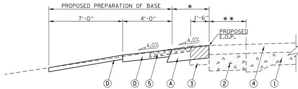
**SECTION A-A FOR EX EARTH / AGGREGATE PE**
