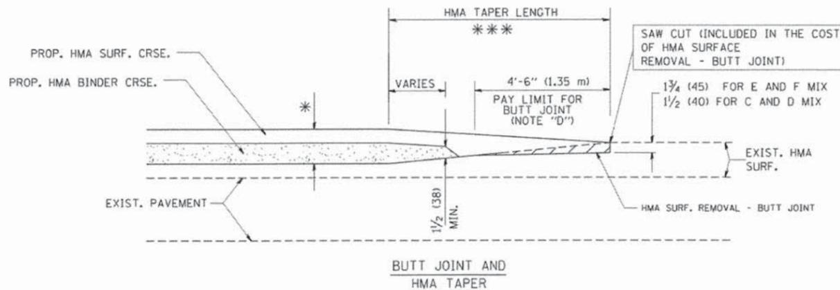
**TYPICAL BUTT JOINT AND HMA TAPER
