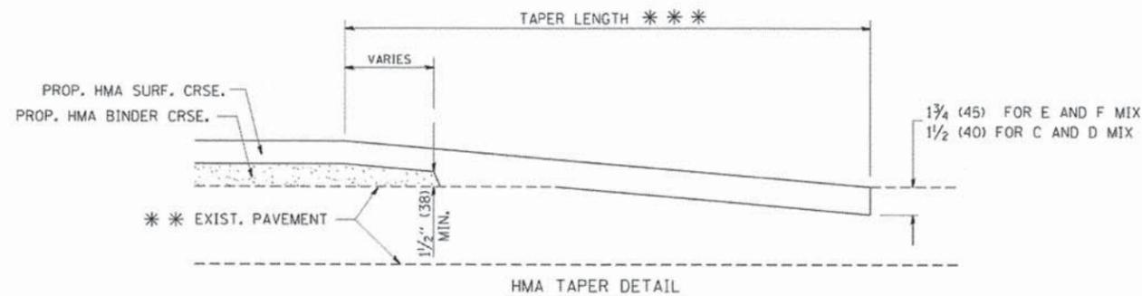
**TYPICAL BUTT JOINT AND HMA TAPER
