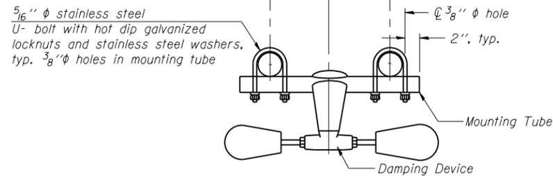
**TRUSS DAMPING DEVICE CONNECTION DETAIL**
