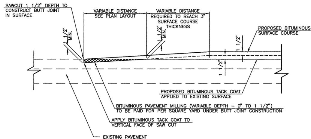
**BITUMINOUS BUTT JOINT CONSTRUCTION DETAIL**
