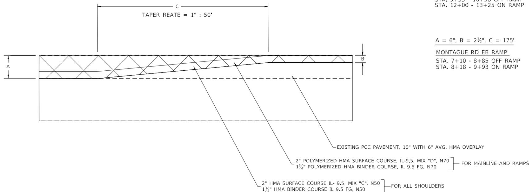
HOT-MIX ASPHALT SURFACE REMOVAL - BUTT JOINT
