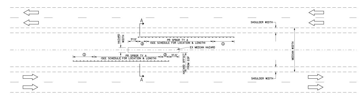
① PR TRAFFIC BARRIER TERMINAL, TYPE 1, SPECIAL (TANGENT)
