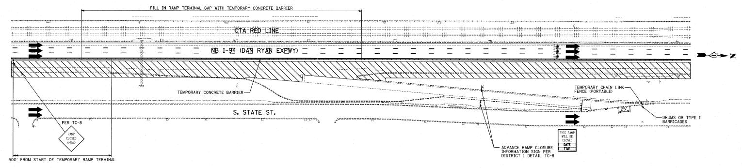
TYPICAL EXIT RAMP CLOSURE FOR STAGES 1 & 1A
