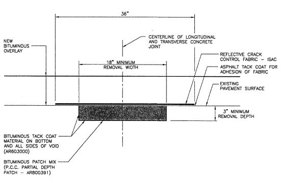
REFLECTIVE CRACK CONTROL FABRIC REQUIRED OVER ALL CONCRETE PAVEMENT JOINTS
