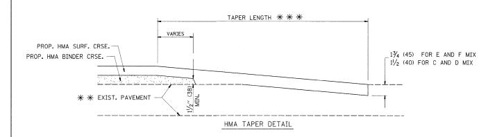
TYPICAL BUTT JOINT AND HMA TAPER
