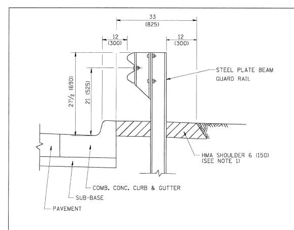
NOTES: 1. THE HMA SHOULDER SHALL EXTEND UNDER THE TRAFFIC BARRIER TERMINAL
