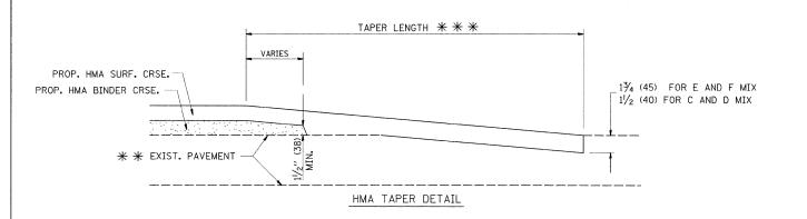
TYPICAL BUTT JOINT AND HMA TAPER
